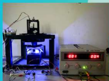
尖端能源材料實驗室 - 懸浮式物理飛輪電池系統
