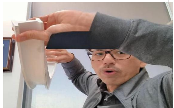
美國瑪莉安大學陳建中教授以實物橡皮梁模擬梁挫屈行為
